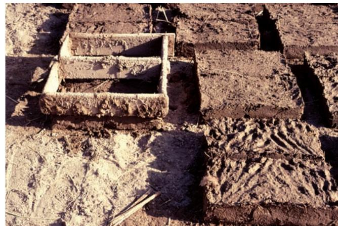
Figura 3. Molde de madera para la elaboración de adobes en el norte de Siria.
