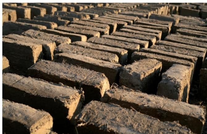
Figura 2. El adobe es el material de construcción característico de la arquitectura mesopotámica. En la imagen, adobes secándose al sol en Siria.
