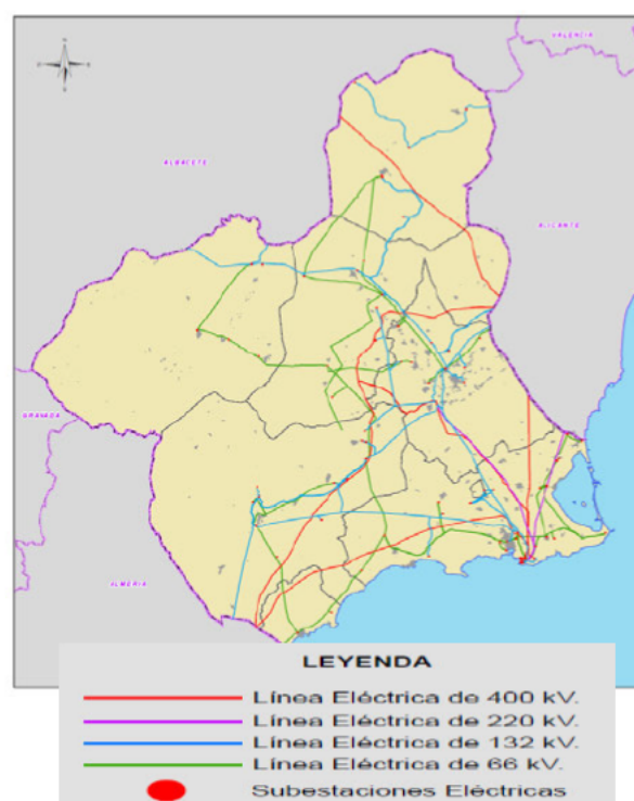
Figura 6. Planta esquemática de la red de distribución de energía eléctrica. (Fuente: Elaboración propia)
